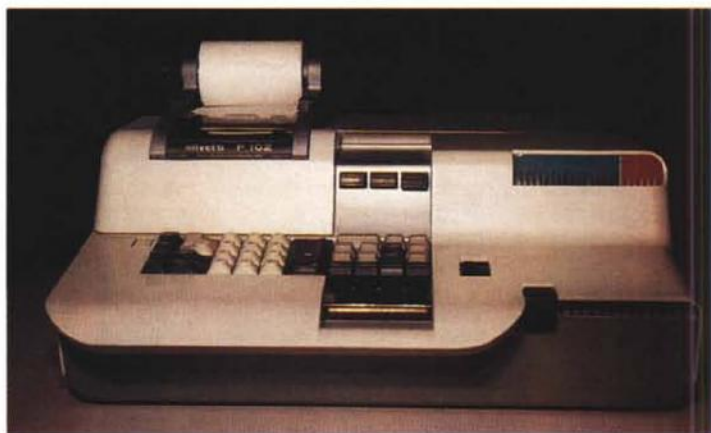
La Olivetti Programma 101 (in foto il modello 102) uscì nel 1965; un elaboratore elettronico personale programmabile completamente transistorizzato che rimase ineguagliato fino a tutto il 1969. Ne furono venduti in tutto il mondo oltre 40 mila esemplari. Fu il primo vero Personal Computer della storia dell'informatica.
